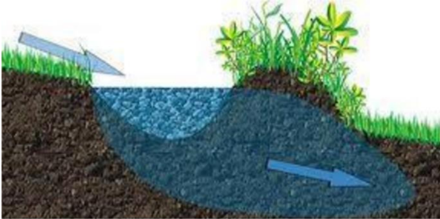
Figuur 85: Een swale is samengesteld uit een ondiepe greppel en een berm (Bron: Reubens et al., 2020).
