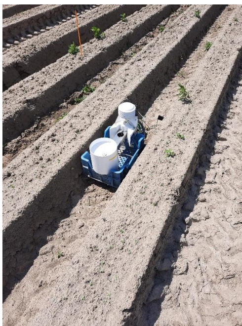
Figuur 42: Met bodemvochtsensoren op het veld meten we het vochtgehalte in de ruggen om een verband te vinden tussen het bodemvochtgehalte en de opkomst.
