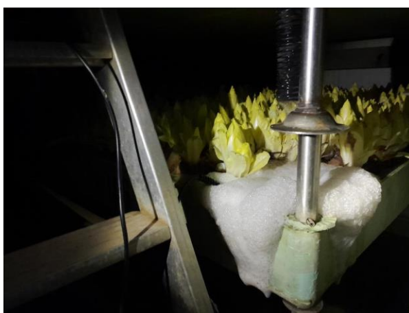
Figuur 44: Grote hoeveelheden schuim en slijm in het forceerwater geven verstoppingen in de meetcellen van de technische apparatuur.
