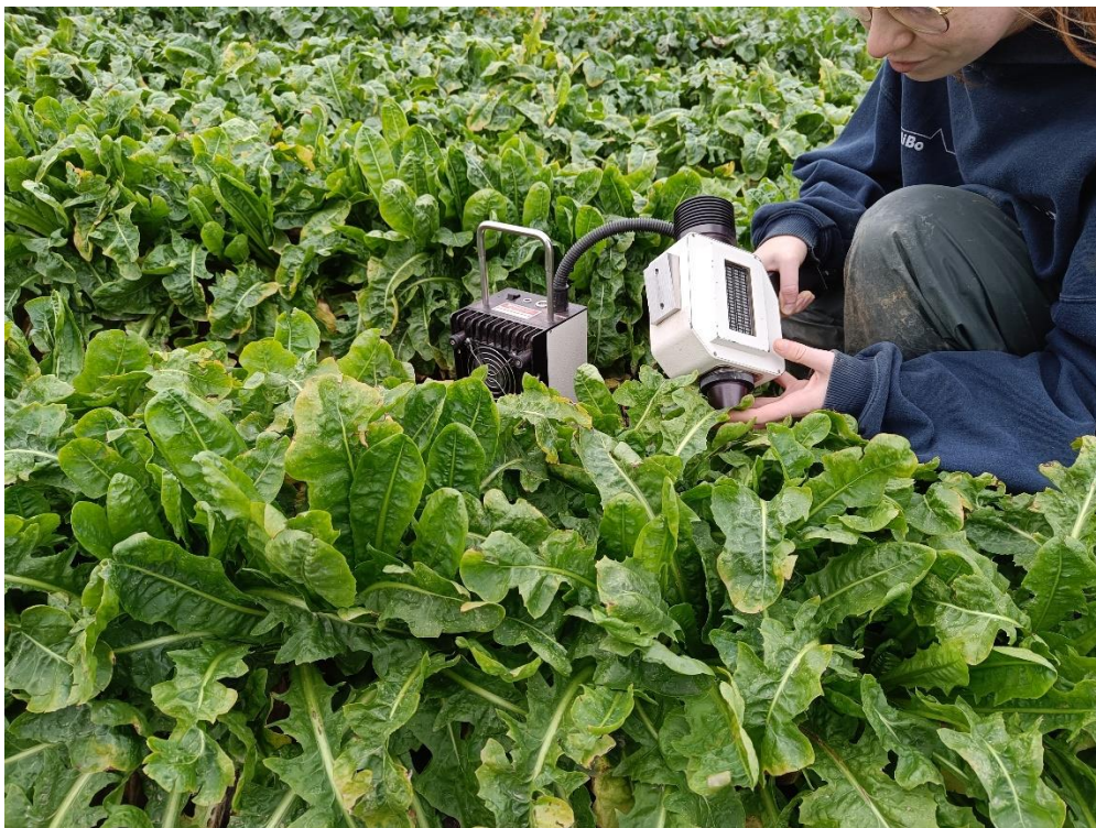
Figuur 43: Met een spectrofotometer wordt de lichtabsorptie van de bladeren gemeten om op basis hiervan het ideale rooitijdstip te voorspellen.
