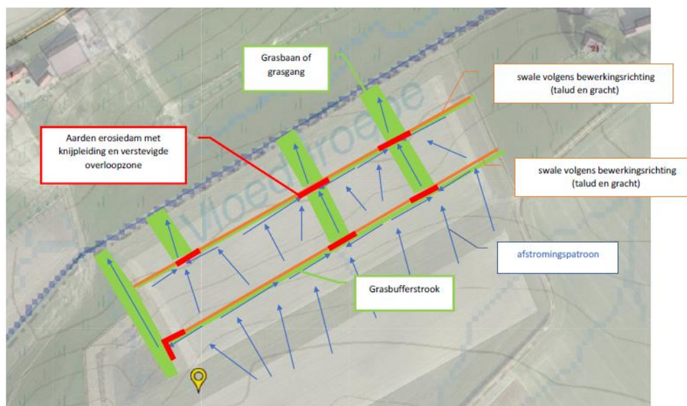
Figuur 7. Swales die niet exact volgens de hoogtelijnen aanliggen moeten gecombineerd worden met grasgangen en bufferende erosiedammen, om effectief te zijn tegen erosie (Bron: Vandaele & Gillijns).
