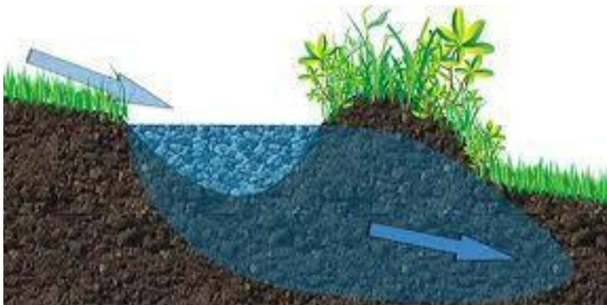
Figuur 1. Een swale is samengesteld uit een ondiepe greppel en een berm (Bron: Reubens et al., 2020).
