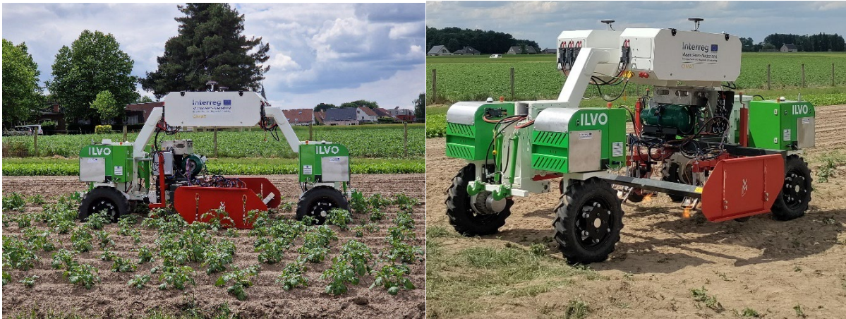
Figuur: onkruidbrander in actie op aardappelveld voor plaats specifieke toepassing tijdens breedschalige demonstratie op ILVO testveld op 31/05/2022.
