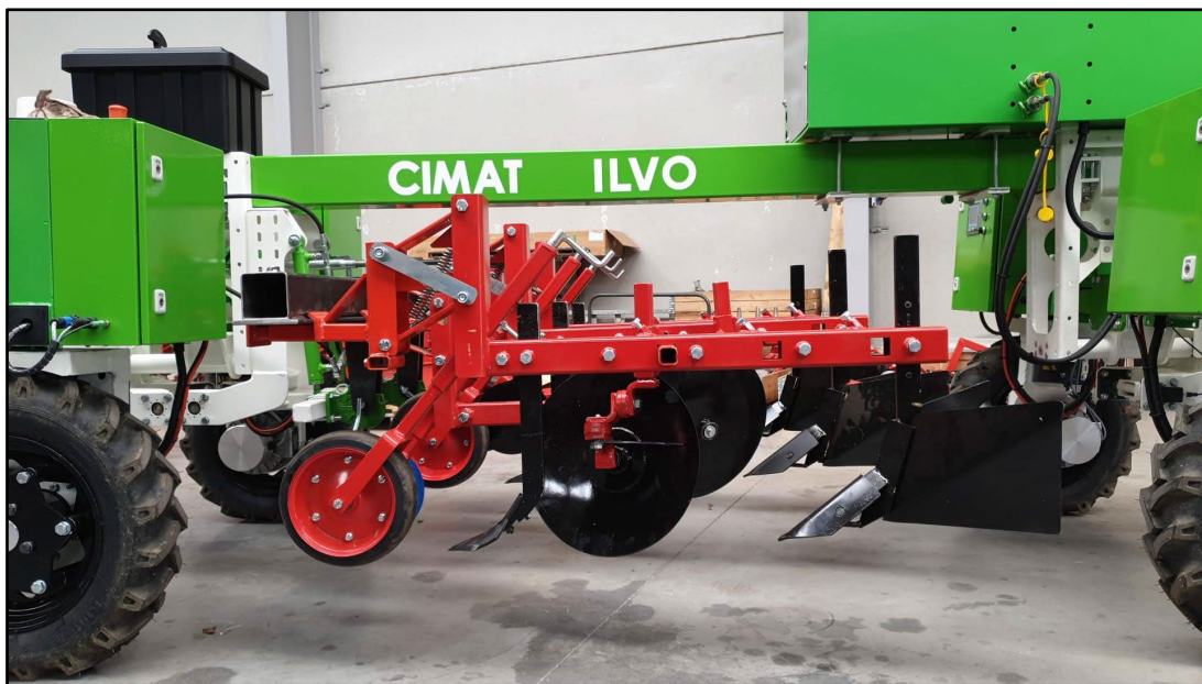
Figuur: schoffelmachine ( versie 1 ) in atelier van Vanhoucke Engineering op 16/07/2021
