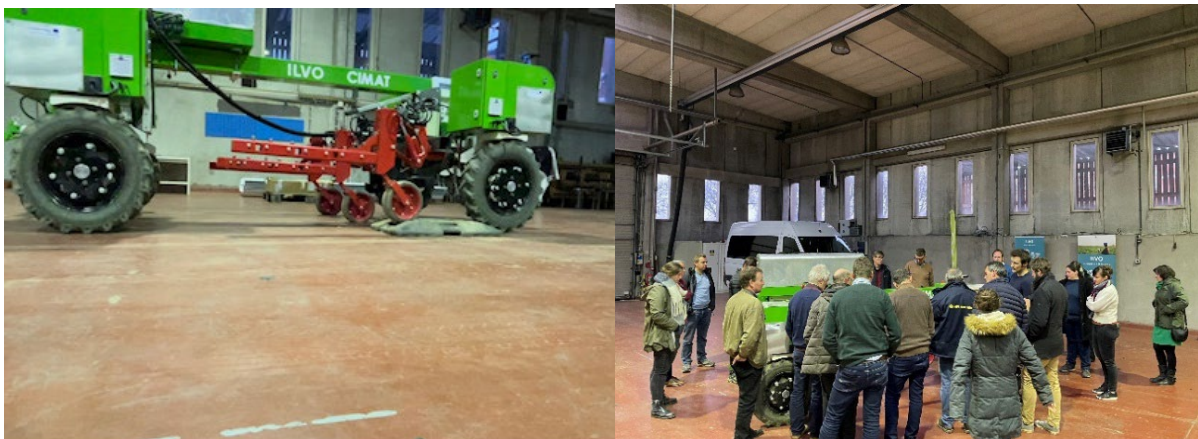
Figuur: Praktijktest met hydraulische schoffelmachine (bovenaan) voorstelling van hydraulische schoffelmachine (schoffelmachine versie 2) voor witloofboeren en onderzoekers van proefcentrum Herent tijdens cocreatiesessie op ILVO op 04/04/2022 (werking hydraulische regeling voor onafhankelijk volgen van de grond met de parallellogrammen links onderaan, co-creatieve sessie aan het platform rechts onderaan).
