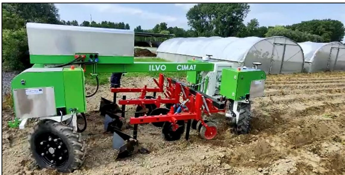
Figuur: schoffelmachine ( versie 1 ) met trekveren tijdens af- en anaardbewerking op een ILVO proefveld (zomer 2021)
