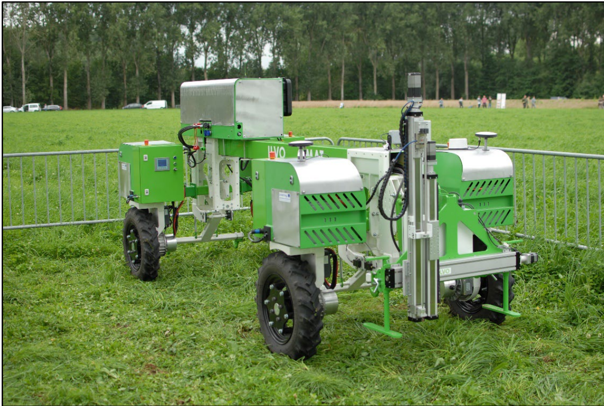
Figuur: Bodemcompactiesensor tijdens co-creatiesessie op het ILVO proefplatform te Hansbeke op 18/08/2021
