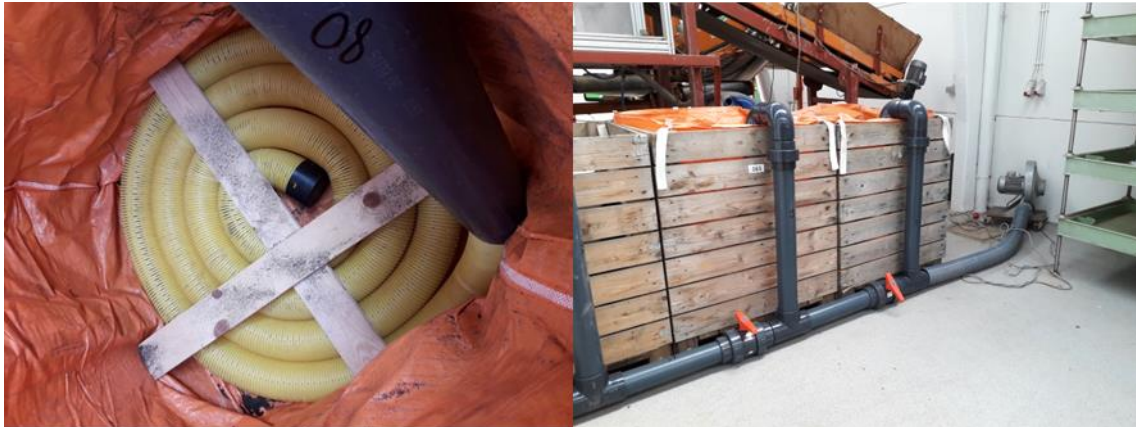
Figuur 2: Een zelfgebouwde drooginstallatie zorgt ervoor dat de bloemen en zaden snel gestabiliseerd worden op het bedrijf. De bloemen of zaden worden bovenop een opgerolde drainagebuis gestort die aangesloten is op een ventilator.
