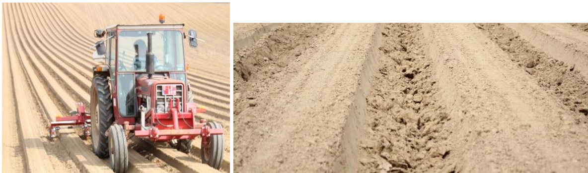
Figuur 5: De vaste tandbewerking door de hydro-dycker van Grimme
