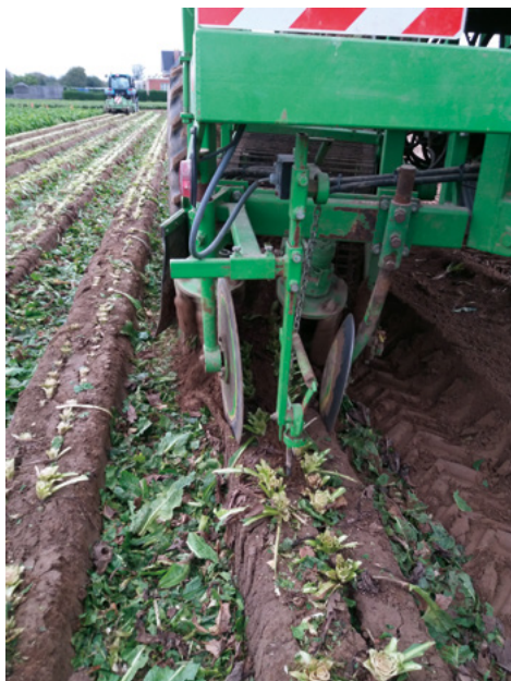
Vermijd beschadiging van de wortels tijdens het rooien: stel de rooimachine goed af.
