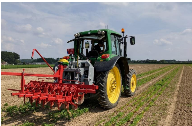
Figuur 73: GPS-sturing op zowel tractor als schoffel laat zeer precies werken toe.
