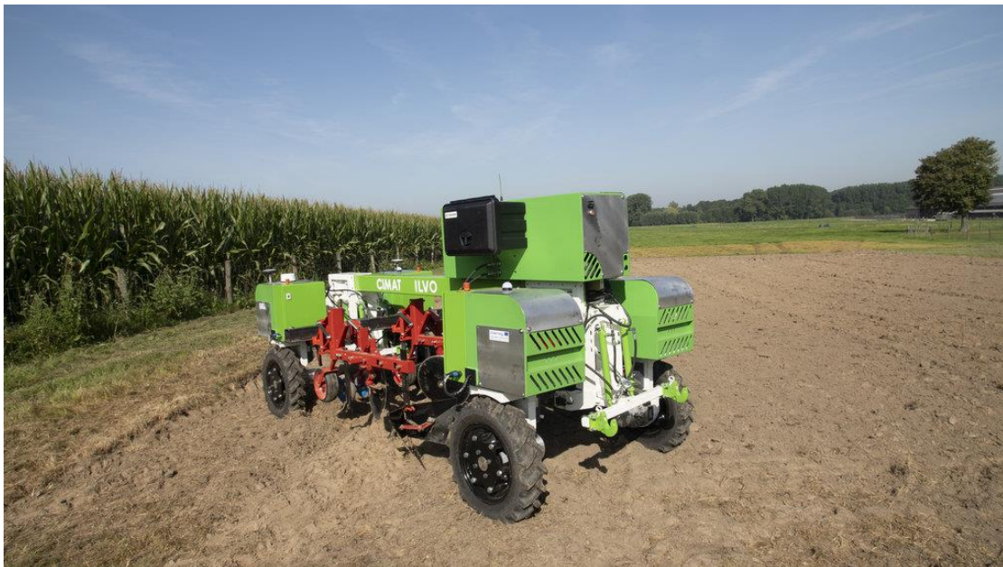
Figuur 63: Nieuw ontwerp van de robot naar het model van een polyvalente werktuigendrager.
